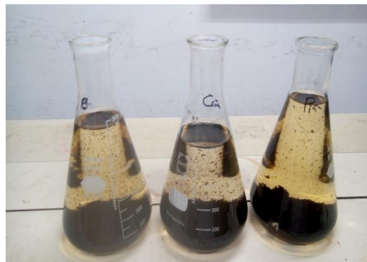
Anexo 8. Residuos de bagazo de caña, corona de piña y pinzote de banano al t_0 , luego de 3h en ebullición.
