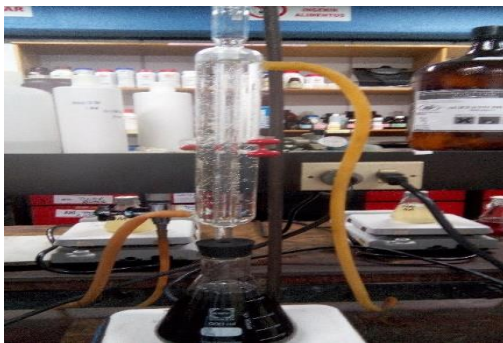
Anexo 6. Muestra de residuo con H_2SO_4 al 4 % conectada a un refrigerante.
