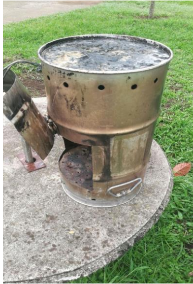
Figura 2. Horno utilizado para la elaboración del biocarbón en San José de la Montaña, Heredia.
