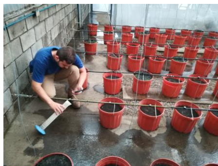
Figura 4. Regulación de la descarga del sistema de riego por goteo, para garantizar homogeneidad hídrica en los sustratos.
